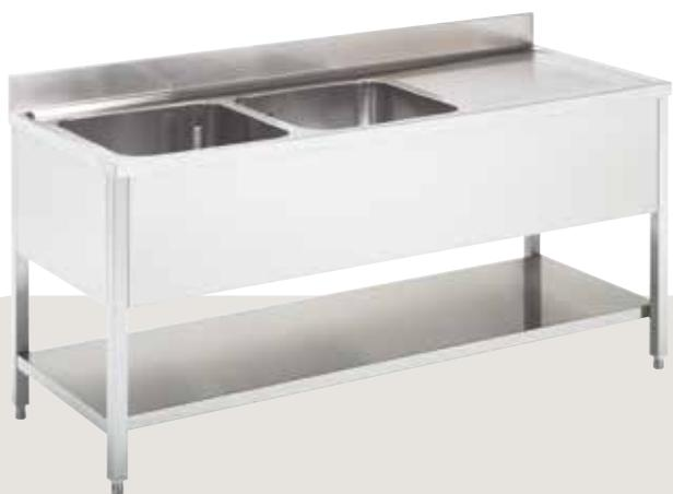
› Lavelli su gambe nella profondità 600 mm nelle lunghezze da 600 a 2.100 mm, ad una vasca e due vasche con e senza gocciolatoio, completi di pilette e troppopieni e ripiano inferiore rinforzato. A richiesta possono essere dotati di laterali (dx-sx). Realizzati in acciaio inox AISI 304 (Cr-Ni 18/10) per garantire la conformità alle norme igieniche.
