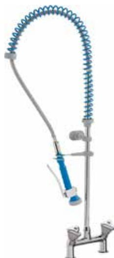
► Miscelatore biforo inclinato da banco "STYL". Vitoni G 3/4 con sede inox. Manopole triangolari mod. "K3". Con gruppo doccia serie "STYL". I gruppi doccia sono forniti completi di valvole di non ritorno. Portata d'acqua: 16 l/min.
