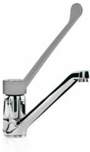
► Monocomando da banco "STYL" con canna girevole incorporata. Portata = 14 l/min. Diametro del foro per l'installazione: 35mm. Allacciamento idrico: flessibili con raccordi filettati femmina G 1/2 (ISO 228-1). Portata d'acqua: 14 l/min.
