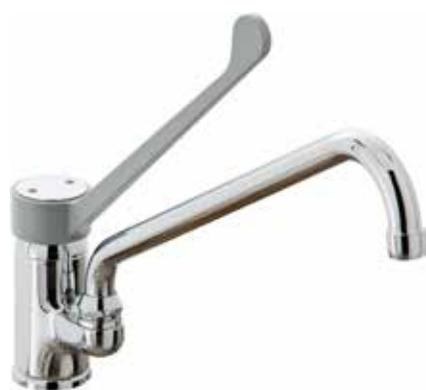
► Monocomando da banco "STYL" con canna girevole in tubo tondo d'ottone. Portata = 14 l/min. Diametro del foro per l'installazione 35mm. Allacciamento idrico: flessibili con raccordi filettati femmina G 1/2 (ISO 228-1). Portata d'acqua: 14 l/min.
