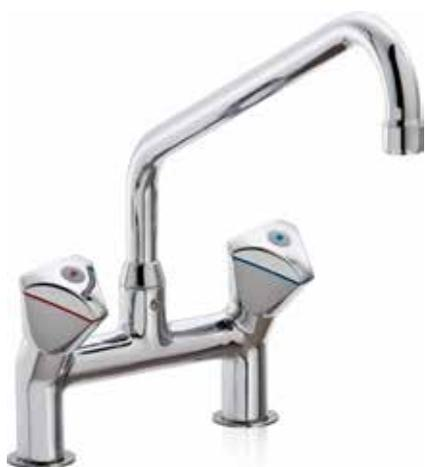
► Miscelatore biforo inclinato da banco "STYL". Vitoni G 3/4 con sede inox. Manopole triangolari mod. "K3". Con canna girevole in tubo d'ottone  $\varnothing$  20. Portata d'acqua: 35 l/min.
