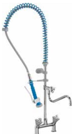
► Miscelatore biforo inclinato da banco "STYL". Vitoni G 3/4 con sede inox. Manopole triangolari mod. "K3". Con canna girevole in tubo d'ottone  $\varnothing$  20 e con gruppo doccia serie "STYL". I gruppi doccia sono forniti completi di valvole di non ritorno. Portata d'acqua: 16 l/min (testa doccia). Portata d'acqua: 35 l/min (canna a S).
